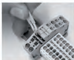
Retrait shunt pour désactiver une résistance (diminution de 300w)
